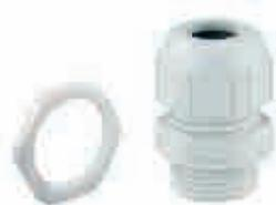
Presse-étoupes, IP68, avec décharge de traction, polyamide, M\_ x 1,5 mm, avec contre-écrou, gris
