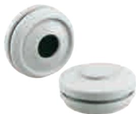
Raccord à double membrane, IP66, avec deux membranes d'étanchéité, fermées, élastomère thermoplastique (TPE), pour épaisseurs de paroi 1,5 - 4,5 mm, gris
