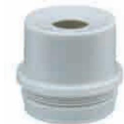
Entrée de câbles IP55, avec membrane d'étanchéité ouverte, élastomère thermoplastique (TPE), pour épaisseurs de paroi de 1,5 - 4,0 mm, gris
